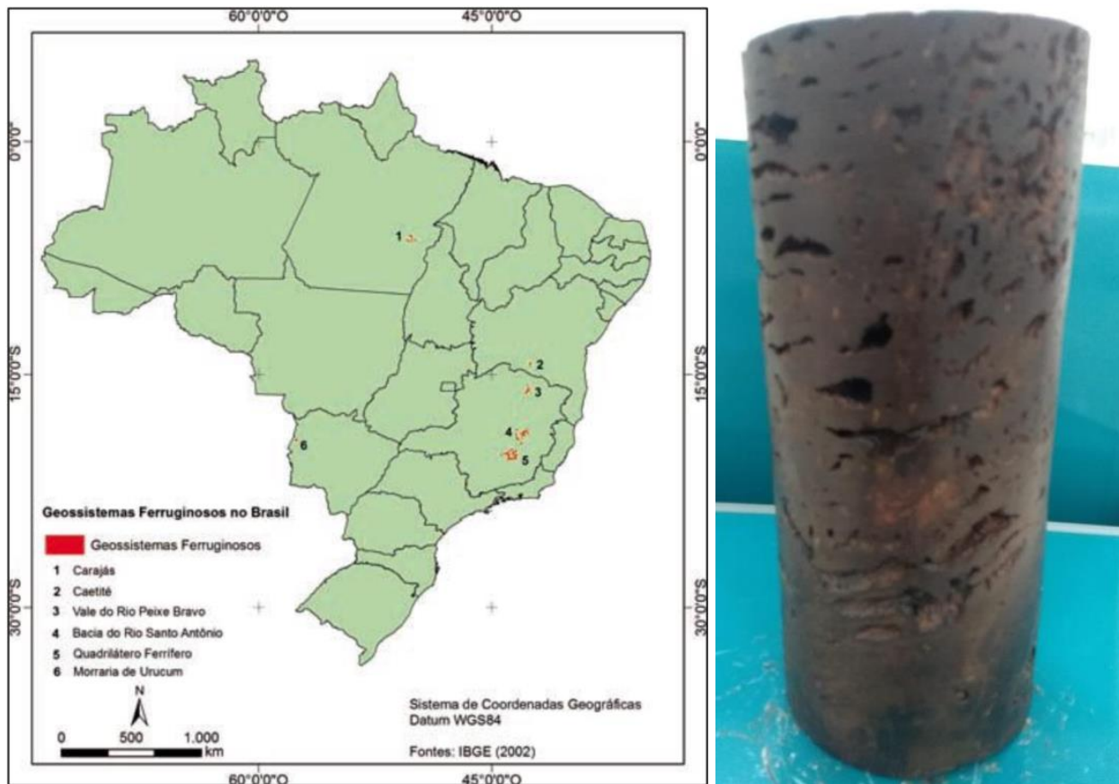
Figura 50. Localização dos geossistemas ferruginosos do Brasil (SOUZA e CARMO, 2015), à esquerda. Testemunho de furo de sondagem de canga em Carajás evidenciando os canalículos e demais falhas presentes no subsolo interceptadas pelos furos de sondagem (direita).
