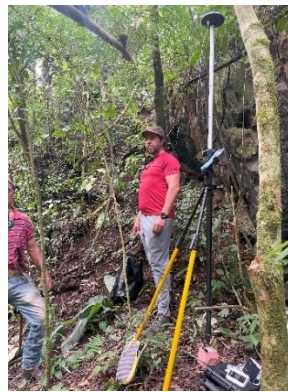
Figura 15: Implementação de marco geodésico no abismo do edifício.
