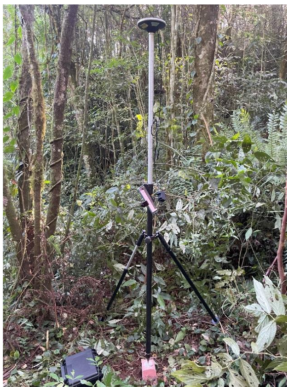
Figura 6: Sistema receptor instalado sobre o marco geodésico para a obtenção de dados de rastreamento GNSS.
