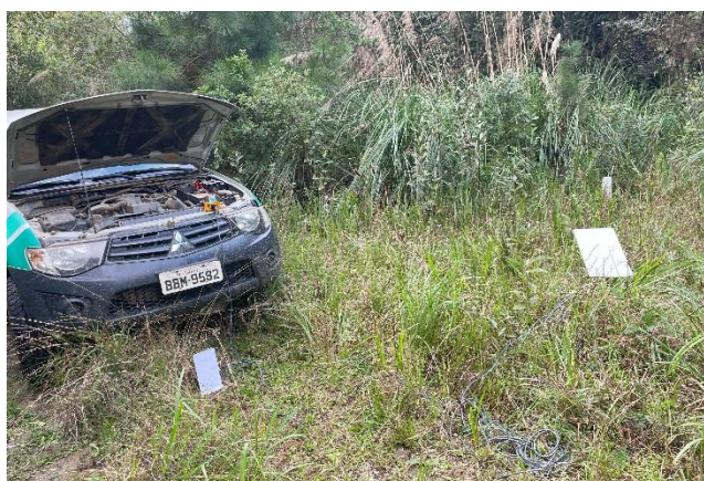
Figura 7: Antena receptora Starlink (direita) e roteador (esquerda) ligados na bateria do veículo (alimentação de energia) para a aquisição e disponibilização de dados de internet para o uso do sistema NTRIP e correção diferencial de dados GNSS em tempo real.
