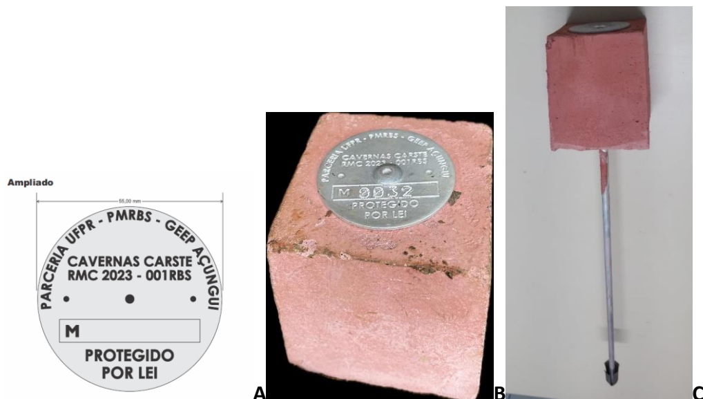
Figura 5: A) Detalhe das informações constantes nos marcos geodésicos; B) Detalhe da placa metálica de um dos marcos geodésicos implantados; C) Vista completa do marco do marco geodésico, reparar a haste metálica de fixação.
